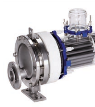
Rohrbündelwärmetauscher mit Stahlumlenkhaube und Sicherheitskammer und SiC-Innenrohren.
