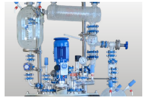
Multipurpose distillation glass overhead with spiral condenser, reflux divider, phase separator and distillate receiver Mehrzweck-Destillation-Glasaufbau mit Spiralkühler, Rücklaufteiler, Phasentrenner und Destillatgefäß
