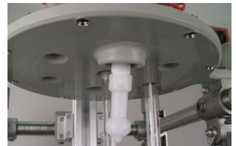
efficient cleaning with CIP spray nozzle effiziente Reinigung mit CIP Sprühkopf
